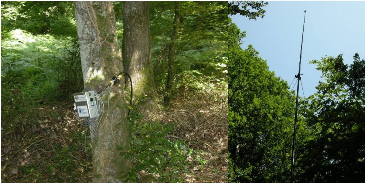
Boîtier d'enregistreur automatique SM2 bat+ (à gauche) et micro en haut d'un mat télescopique (à droite) – Photos : Thomas DUBOS.
