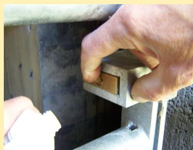
Enfin appliquer un peu de graisse sur l'entrée de la clé, dans le but d'éviter que l'eau et les poussières ne pénètrent dans le rotor.
