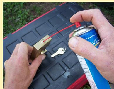
En positionnant le cadenas à la verticale, injecter abondamment le lubrifiant.
