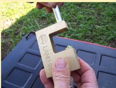
Ouvrir totalement l'anse et lui appliquer un mouvement de rotation pour bien graisser la bille de sécurité.
