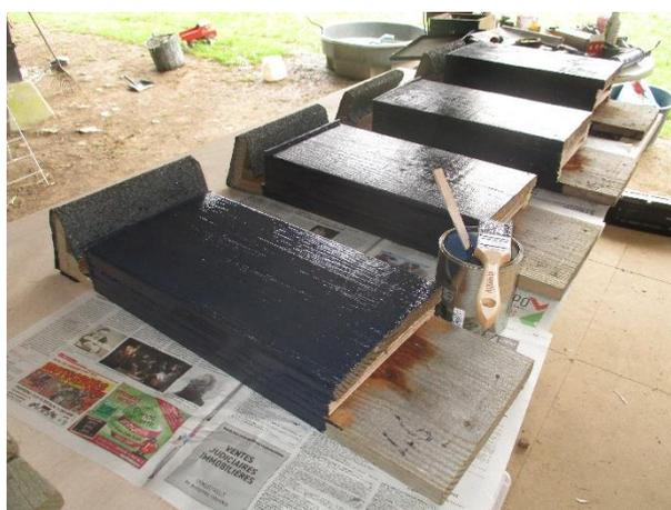
**Remarques** : 4 épaisseurs par type de parement voire photo. Contreplaqué griffé et percé à la scie-cloche (~45 mm) dans la partie supérieure pour une communication entre les chambres.
